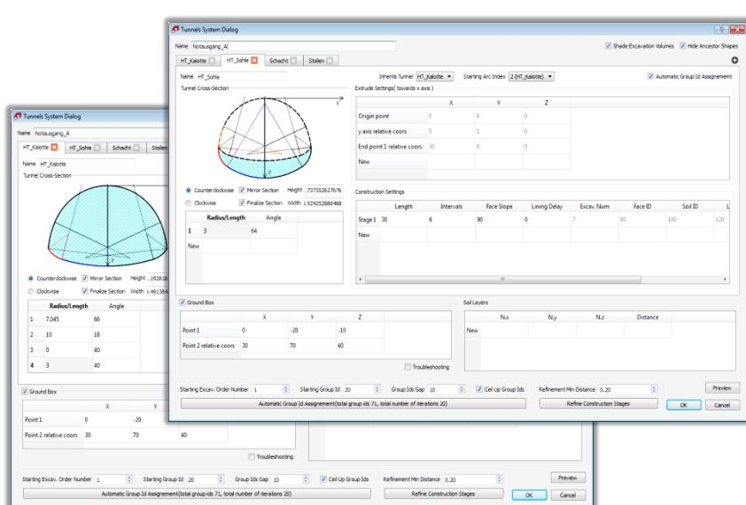
Die im Tunnel-System-Dialog gemachten Eingaben werden zusammen mit dem Modell abgespeichert, so dass der Dialog jederzeit wieder aufgerufen werden kann. So lassen sich nachträgliche Änderungen oder Varianten der Geometrie, der Querschnittsunterteilung, der Abschlagslängen, der Bauphasen, etc. sehr einfach realisieren.
