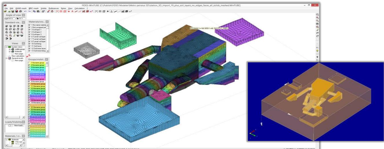
Die geometrischen Objekte des FIDES-Modellers sind vollständig parametrisiert und assoziativ voneinander abhängig. Wird z.B. eine Tunnelröhre nachträglich verschoben, werden die Verschneidungen automatisch an der neuen Position durchgeführt.
