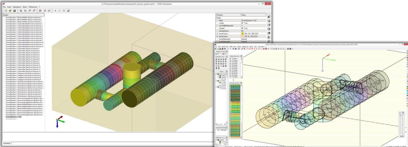
Selbstverständlich sind im FIDES-Modeller auch allgemeine Tools zur manuellen Eingabe und Manipulation der Geometrieeobjekte verfügbar, so dass auch spezielle Geometrien wie kontinuierliche Aufweitungen, Ausrundungen, etc. (sogar im Zusammenspiel mit dem Tunnel-System-Dialog) erzeugt werden können.
